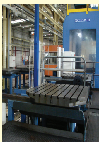
FOREST LINE FLEXIAX 410 (1987) 10 palettes 1.250 x 1.250 mm, X = 2.000, Y = 1.250, Z = 1.250 mm, B 360.000 positions, chang. auto. d'outils 100 positions, palpeur RENISHAW, navette d'approvisionnement, CN NUM 760.
