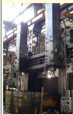
RAFAMET KCF 200 (1969), Ø 2.000 / 2.230 mm, hauteur 1.250 mm, charge 10 T, 4 mors indépendants
