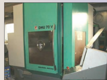
Centre Verticale DMU Type 70 V Année 10/1998 CNC-3d-HEIDENHAIN
