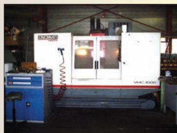
Centre d'usinage vertical CINCINNATI ARROW 1000 de 1998, TNC 426 HEIDENHAIN, 1000 x 500 x 560 - TBE
