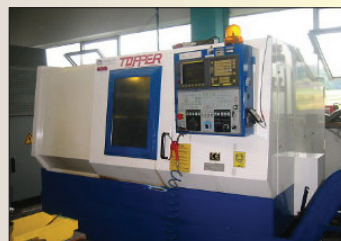
Tour CNC TOPPER TNL 100 de 1996 FANUC OTC - BE Ø 250 x 450 mm - Prix : 23 000 €
