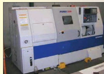
Tour CNC DAEWOO PUMA 230 C de 1998 - Ø 300 x 550 FANUC OTC Convoyeur à copeaux
