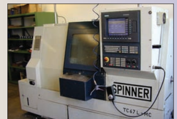
Tour SPINNER Type TC 67L Année 1997 - 3 axes Siemens 840D
