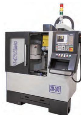
AV Centre d'usinage de 2013 - Neuf - X : 300, Y : 180, Z : 210 mm - Mag. : 12 outils BT30 - Br : 2,2 Kw - Vendu avec lot de porte outils - Prix : 29 900 Euros net HT
