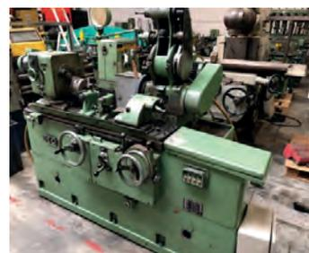
AV Rectifieuse cylindrique inter/exter CONSTRUCTION DE CLICHY - Type CC5010 - Hauteur de pointe : 130 mm Longueur de rectification : 500 mm Appareil intérieur basculant - Vitesse de la meule extérieure : 2840 tr/mn Diamètre de la meule : 300 mm Diamètre du mandrin : 150 mm - Vitesse maximum du mandrin : 900 tr/mn Accessoires inclus : Lunette 2 touches, Appareil à diamanter - Prix : 5 500 Euros HT - Tél : 06 07 68 86 74
