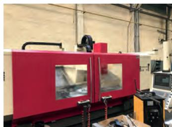
CU vertical HEDELIUS super état - CN Heidenhain TNC 426 - Table 3900 x 750 mm - X 3200 x Y 800 x Z 600 mm Rapides 30m/min - Broche 8000 Tr/min ISO 40 - Magasin 30 outils - Arrosage au centre 20 bars - Mode pendulaire sans cloison - Convoyeur à copeaux large Tél : 04 76 37 53 26
