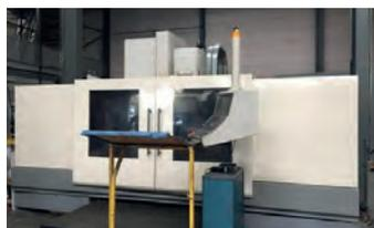
AV Centre d'usinage HARTFORD VMC 2060 Mercury - CNC Heidenhain TNC 426 - Courses : 2000 x 800 x 660 mm Table : 2100 x 850 mm - Puissance de borché : 18.5 kW - Vitesse de broche : 6000 tr/min - Boite de vitesse - Poids maxi sur la table : 2.5 T - Poids machine : 17.2 T - Changeur d'outils 30 positions BT 50 - Arrosage par le centre de la broche Palpeur de pièces - 2 convoyeurs à copeaux - Glissières prismatiques Machine disponible sauf vente entre temps - Tél : 06 09 14 93 74
