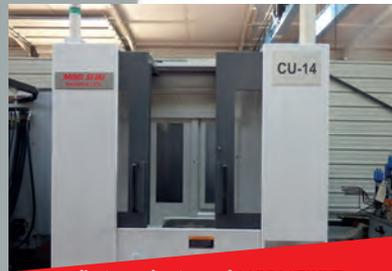
**Centre d'usinage horizontal MORI SEIKI Type NH4000 DCG** - Dimensions palette 400 x 400 mm
