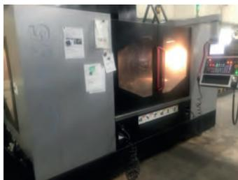
AV Centre d'usinage vertical WELE
