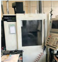
Centre d'usinage 5 axes
