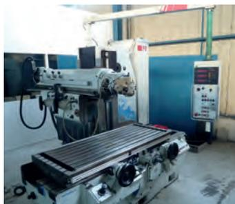
AV Fraiseuse HURON PU 551 - Année 1994 - Surface de la table : 1635 x 700 mm - Courses XYZ : 1300 x 1000 x 1000 mm - Nombre de vitesses de broche : 27 Gamme des vitesses : 30 à 2066 tr/min Cône de broche : SA 40 + Visu 3 axes Heidenhain - Variateurs d'avances
