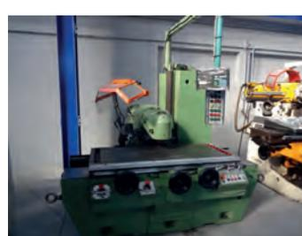
AV Fraiseuse HURON PU 771 - Table : 1635 x 700 mm - Béliet (Y) : 1000 mm Z : 1000 mm - Rotation de 30 à 2066 tr/min - Tête réversible SA 50 / SA 40
