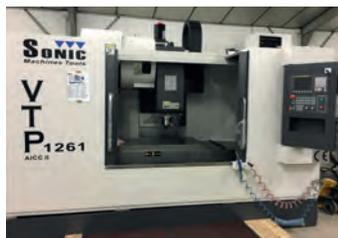
AV Centre d'usinage SONIC - Fanuc 0i MF avec carte AICC2 - Broche : BT 40, 12 000 tr/min, 15 kw - Arrosage centre broche : 20 bars - 4 glissières prismatiques surdimensionnées - Courses XYZ : 1250 x 610 x 610 mm - Changeur 24 outils à bras - Charge admissible : 1200 kg - Valeur : 112 900 Euros - **Vendu : 92 900 Euros HT départ** - Garantie 1 an PMO - Tél : 06 88 21 67 62
