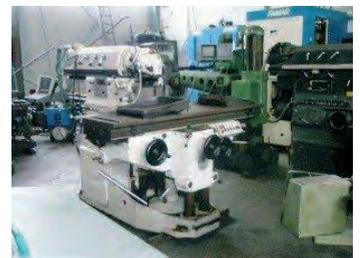
AV Fraiseuse HURON MU4 avec variateur - Refaite - Repeinte - Nouvelle visu Heidenhain - TBE
