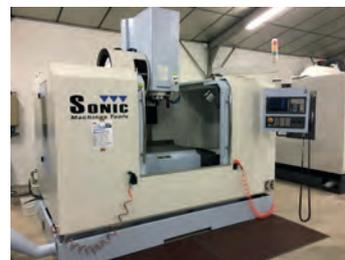
AV Centre d'usinage SONIC - Siemens 828 D avec Shopmill - Broche : BT 40, 6000 tr/min, 15 kw - Boite de vitesses Glissières prismatiques surdimensionnées - Courses XYZ : 1020 x 600 x 550 mm - Changeur 24 outils à bras Charge admissible : 800 kg - Valeur : 92600 Euros - Vendu : 72 900 Euros HT départ - Garantie 1 an PMO
