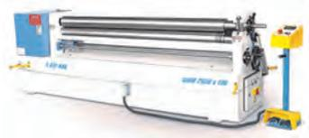
AV Rouleuse asymétrique motorisée à 3 rouleaux SIRM 2050 x 4 mm - Capacité de roulage (longueur x épaisseur) : 2050 x 4 mm - Ø du rouleau : 140 mm - Ø de cintrage minimum : 210 mm - Vitesse de roulage : 3,5 m/min - Puissance moteur rotation des rouleaux : 2,2 kw Dispositif de roulage conique - Panneau de commande sur pied - Normes CE Dimensions machine : 3200 x 750 x 1000 mm - Poids : 1700 kg - Prix spécial : 8 550 Euros - Tél : 06 07 68 86 74
