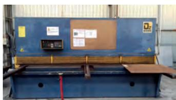
AV Cisaille guillotine OZBORN - Type CGH 3212 - Année 2011 - Epaisseur de cisailage : 12 mm - Longueur de cisailage : 3200 mm - Passage entre flancs : 3465 mm - Nombre coups : 9 - Course butée arrière : 800 mm
