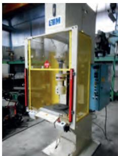
AV Presse L B M - Type BG 162 - Puissance : 16 tonnes
