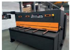
AV Cisaille AMADA - 2000 x 4 mm - Butée arrière : 1000 mm - Tél : 03 20 10 30 40
