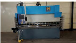
AV Presse plieuse HACO ERM 30135 - Fastbend 2D premium - Out rect haut et bas - Bombage CNC - X, R, Z1, Z2 - Serrage rapide - Tél : 03 20 10 30 40
