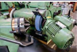
AV Affûteuse de forêts automatique ULRICH KLINGEL BSA - Mandrins de serrage à 6 machoires de précision : No. R 269 - ø de serrage : 3-40 mm - Marque Röhm concentricité : 0,04 mm - Vitesse d'outils : 6 - 60 trs/min - Capacité de commande d'outils : 0,09 kW
