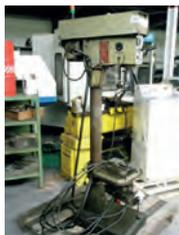
AV Perceuse à colonne ADAM MC 22 - Dia : 30 mm
