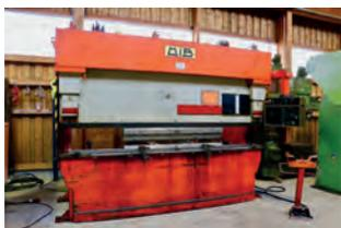
AV Presse plieuse MIB 125 Tonnes - CNC Cybelec DNC 7000 - 3 axes : Y1, Y2, X, Z1, Z2, Z3, Z4 manuels - Longueur : 3450 mm - Passage entre montants : 3100 mm - Col de cygne : 310 mm - Tél : 03 88 68 01 37 - Mail : info@cpmo.fr
