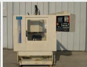
**Centre d'usinage 3 axes REALMECA type CU 300V**
