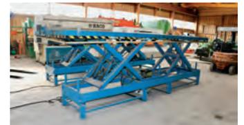
AV Table élévatrice grande dimension 2 tonnes Hydraulique - Dimensions : 800 x 5000 mm - Hauteur repliée : 800 mm - Hauteur déployée : 1600 mm Mode descente auto. - Charge : 2 tonnes
