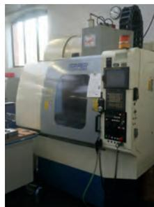
AV Centre d'usinage vertical TOPPER 850 A - Fanuc
