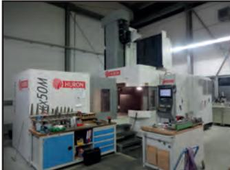
Centre de fraissage portique 5 axes HURON KX 50
