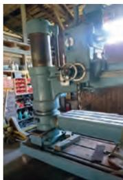
AV Perceuse radiale GSP - Type 405 TI25 - Blocage hydraulique - Cône de broche : CM 4 - Rayon max de perçage : 1400 mm - Rayon mini de perçage : 465 mm
