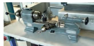
AV Tour conventionnel SCHAUBLIN 70 sur établi Passage sur le banc : 130 mm - Distance entre pointes : 275 mm - Armoire électrique neuve - Chariot croisé Machine en très bon état - Tél : 04 77 73 00 82
