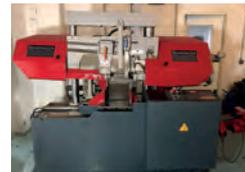
AV Scie BEHRINGER HBP 263 A - 1998 - Capacité en rond : 260, à plat : 260 x 300 - Automatique avec aménagement de 500 mm - Tél : 06 72 10 88 98
