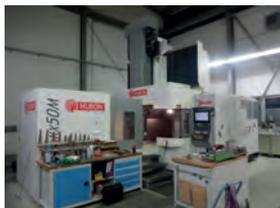
AV Centre de fraiseage portique 5 axes HURON KX 50 - X 2000 x Y 1700 x Z 800 mm - Table : 2200 x 1250 mm - Charge 4 T - Electrobroche Kessler 20.000 rpm - 60-75 Kw - Cône HSK63 - Changeur 30 outils Shopmill - Palpeur - Mode 3D - Tél : 06 88 94 32 50
