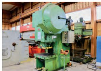
AV Presse mécanique VEB - Puissance : 100 tonnes
