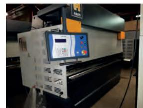
AV Presse plieuse PPH 40135 - Rétrofit ATL 565 - Out
