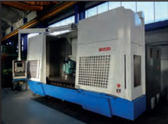
Fraiseuse 4 axes HURON EX 30 - CN Heidenhain
