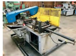
AV Scie à ruban automatique ULTRA TR 370 APS Dia. de coupe maximum (rond) : 250 mm - Coupe maximum rectangle : 340 x 250 mm - Temps de cycle optimisés grâce à la course de la barre (1000 mm) qui limite les reprises
