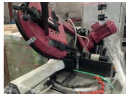
AV Scie à ruban BEHRINGER type SLB 230 DG De 2017 - 240 mm en rond - 310 mm en plat Coupe d'angle : -45° +60° - Descente et remontée automatique - Plateau et étai massifs en fonte Serrage manuel avec poignée rapide - Entièrement révisée par Behringer - Tél : 03 80 78 72 62
