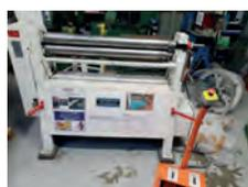
AV Rouleuse à 3 rouleaux motorisés SAHINLER - Type RM 1050 x 90 - Année 1999 - Capacité de roulage (long. x ép.) : 1050 x 3 mm - ø du rouleau : 90 mm Vitesse de roulage : 6 m/min - Puissance moteur rotation des rouleaux : 1,1 kw - Dispositif de roulage conique - Panneau de commande sur pied - Normes CE - Dimensions machines : 1630 x 700 x 1200 mm Poids : 455 kg - Tél : 01 34 08 42 44
