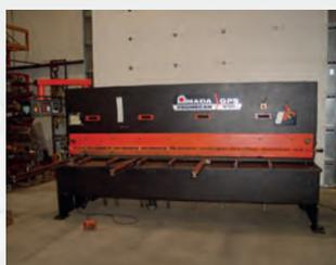
**Cisaille hydraulique AMADA type GPS 630**
