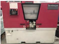
AV Scie à ruban BEHRINGER type HBE 321 A - 2014 Entièrement automatique à descente sur 2 colonnes Capacité : 350 x 320 mm - Avance hydraulique - Commande BT 35 intuitive - Aménagement par vis à billes : 650 mm - Equipé d'un convoyeur à copeaux et pistolet d'arrosage - Entièrement révisé par Behringer - Tél : 03 80 78 72 62
