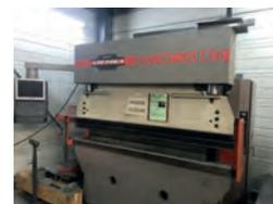
AV Presse plieuse SYNCHRO CN PERROT 2500 x 60
