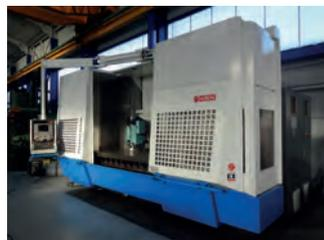
AV Fraiseuse 4 axes HURON EX 30 Année 2001 - CN Heidenhain - X 2400 x Y 700 x Z 800 - Table : 2800 x 750 - Puissance : 25 Kw - Rotation : 14k tr/min - Cône HSK63 - Tête axe B continu +/- 90° incrément 0,001° Rapides : 30 m/min - Changeur - Tél : 06 88 94 32 50
