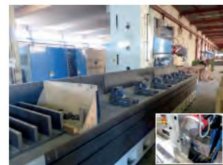
AV Fraiseuse table fixe et montant mobile NOVAR KDN - Année 1974 - CNC Num 1060 - Surface de table : 8000 x 1000 mm - Courses XYZ : 6428 x 965 x 1791 mm - Cône de la broche ISO 50 - Vitesse de broche : 10 à 2250 t/mn - Moteur de broche : 15/22 kw - Tête auto HV - Machine en bon état - Tél : 06 09 14 93 74
