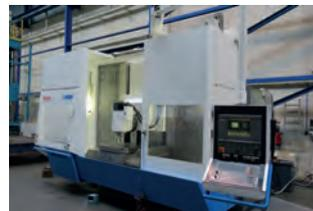
AV Fraiseuse 5 axes simultanés HURON EX - Année
