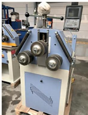
AV Cintreuse de profilés type SPK 35 Neuf - Système horizontal et vertical - Diamètre des arbres 50 mm - Diamètre des Galets : 155 mm - vitesse de travail 4.5 m/mn - Entraînement des deux galets par Motoréducteur 1.5 KW - Fer plat : 100 x 15 ; Cornière : 50x50x6 ; UPN 80 ; Carré : 35x35 mm - Machine Neuve Disponible sauf vente entre temps : 4 590 Euros HT. Tél : 06 07 68 86 74
