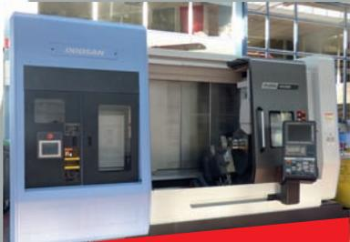
**Centre de tournage fraisage DOOSAN SMX 2600S** - CNC FANUC 311B
