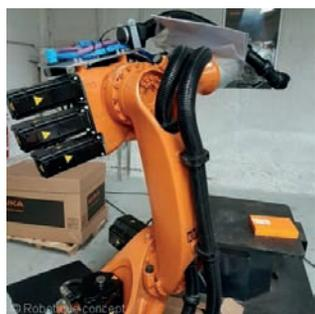
AV KUKA kr16-2 baie KRC4 , dernière génération, quasi neuf. Année 2017. rare si récent en occasion, n'a fait que des démonstrations. Rayon d'action : 1610 mm. Charge embarquée : 16 Kg. Configuration exacte : Config: KR 16-2. Low Payload (5 kg - 16 kg). Robot bénéficiant des 10 garanties RC.
