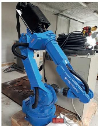
AV YASKAWA EA1900N + FRONIUS Transpulsynergic 3200 & welding equipement. Année 2005. Prêt à souder , déjà interfacé. Excellent état, très robuste. Grand rayon : 1905 mm, 3 kg de charge. Prix incluant le décréasseur de torche. Robot bénéficiant des 10 garanties RC.
