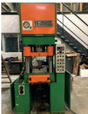
AV Presse hydraulique LOCATELLI T125-4C - 125 T - Table 450x380 - Pression de travail 300 bar - Vitesse d'approche 350 mm/sec - Vitesse de compression 3,3 mm/sec - Garantie 3 mois - Prix : 29 500 Euros HT. FOREZ MACHINES. Tél : 04 77 02 37 50
