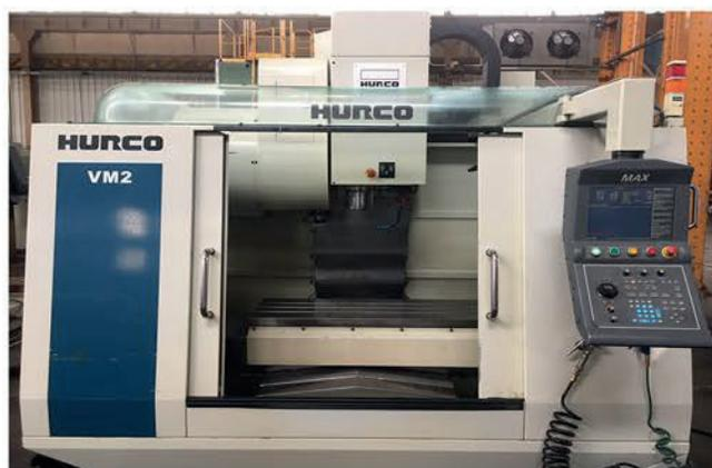
**CENTRE D'USINAGE 3 AXES
