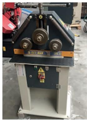
AV Cintreuse de profilés type SPK 30 Neuf - Système horizontal et vertical - Diamètre des arbres 30mm - Diamètre des Galets - vitesse de travail 2-4 m/mn - Fer plat : 80x15 ; Cornière : 40x40x5 ; Carré : 30x30 mm - Machine Neuve Disponible sauf vente entre temps : 3 290 Euros.
