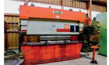
**Presse plieuse MIB 125 Tonnes CNC**
