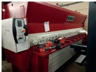
AV Cisaille guillotine HACO HSLX 4013 - Commande numérique - Butée escamotable - Course : 860 mm
