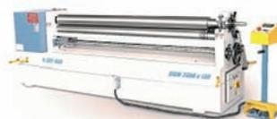
AV Rouleuse Asymétrique Motorisée Type SIRM 2050 X 4 mm Neuf - Capacité de roulage (longueur x épaisseur):2050 x 4 mm - Diamètre du rouleau 140 mm - Diamètre de cintrage minimum : 210 mm - Vitesse de roulage 3,5 m/min - Puissance moteur rotation des rouleaux : 2,2 KW - Dispositif de roulage conique - Panneau de commande sur pied - Normes CE - Dimensions machine : 3200 x 750 x 1000 mm - Poids 1700 kg - Prix spécial 8 950 Euros.
