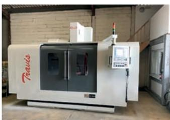
AV Centre d'usinage M1500, X 1500 ; Y
