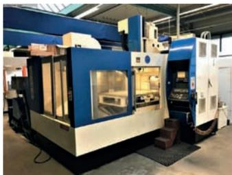
AV Centre d'usinage HURON KX30
