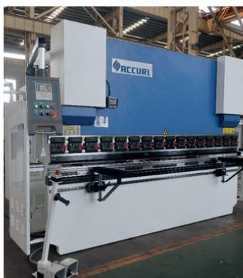
AV Presse Plieuse Hydraulique ACCURL Type MB7 3200 X 125 T - Neuf - Puissance : 125 tonnes - Longueur de pliage : 3200 mm - Entremontant : 2550 mm - Col de cygne : 320 mm - Puissance : 11 kW - Encombrement machine : 3790x1935x2420 mm - Poids : 8000 kg - EQUIPEMENT STANDARD : Système de contrôle : ELGO P40 NC (Ecran TACTILE) - Nombre d'axes : 2 axes (Y, X) - Bombé de table Manuel - Affichage graphique 2 D - Protection latérale par LASER DSP. Prix de lancement à partir de : 34 500 Euros.
