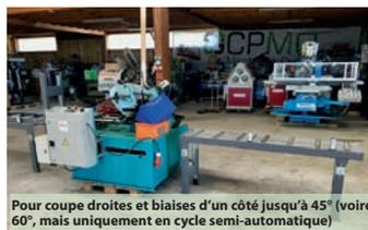
Pour coupe droites et biaisées d'un côté jusqu'à 45° (voire 60°, mais uniquement en cycle semi-automatique)
