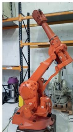
AV ABB IRB 2400 IRC5 (dernière génération) version fonderie. Année 2007. Capacité : 16 kg, rayon d'action : 1500 mm. Modèle M 2004 2400/16 version 2. En option embase de 500 mm de haut. 100% testé et révisé. Dans notre stock : même robot en version S4C M97 et 10 kg. Robot bénéficiant des 10 garanties RC.
