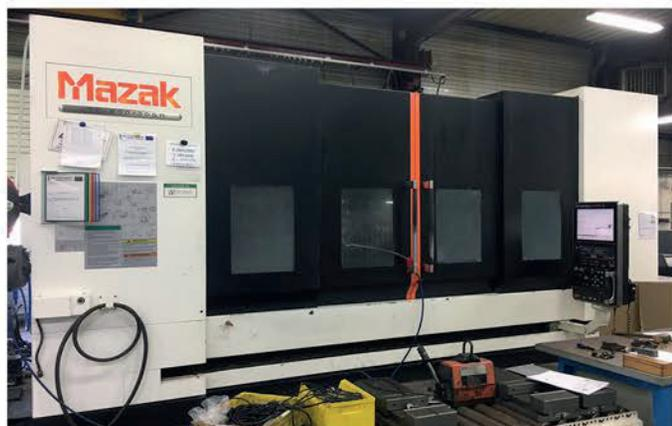
**CENTRE D'USINAGE 5 AXES
