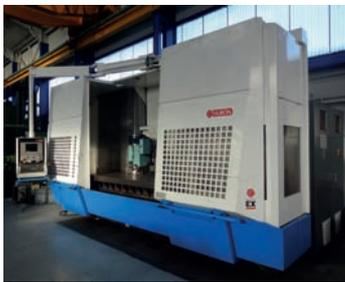
AV Fraiseuse 4 axes HURON EX 30
