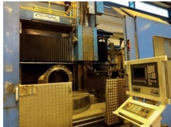
AV Tour vertical TITAN SC 22 - Année 2007 - CNC Siemens 840D - Diam plateau : 2000 mm - Charge : 12 T - Rotation maxi : 140 tr/min - Broche fraisage : 2000 tr/min - 22 Kw - Axe C - 2 changeurs d'outils - Filtration Convoyeur - Tél : 06 88 94 32 50
