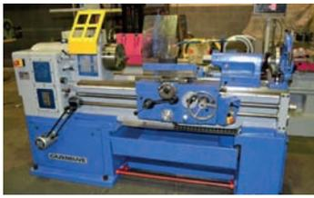
AV Tour parallèle CAZENEUVE HB 500 x 1000 - Machine entièrement reconstruite, refaite à neuf - Distance entre pointe : 1000 mm - Hauteur de pointe : 200 mm - Diamètre admis au dessus du banc : 500 mm - Diamètre admis au dessus du chariot : 220 mm - Alésage broche : 40,5 mm - Conicité de la contre pointe : CM4 - Course maxi du chariot transversal : 400 mm - 18 vitesses de broche : 25 à 2000 tr/min - Puissance moteur de broche : 8,8 kW - Norme CE
