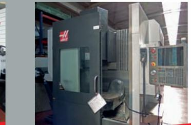
**Centre d'usinage vertical 5 axes HAAS UMC 750** - CN HAAS - ST 500 x 500 mm
