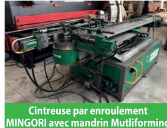
**Cintreuse par enroulement MINGORI avec mandrin Mutlifforming**
