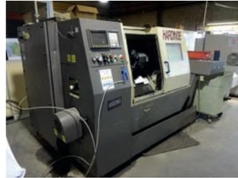
AV Tour CN HARDINGE Cobra 42 - CN Fanuc 21 - Mandrin Gamet - Diam : 170 mm - Diam max 209 x longueur 255 mm - Rotation : 5000 tr/min - Puissance : 7,5 kW - VDI 12 positions - Convoyeur Contrepointe - Petit prix - TBE
