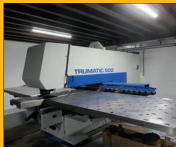
**Poinçonneuse TRUMPF Trumatic 500R**
