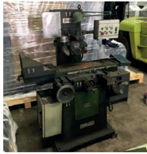
AV Rectifieuse plane PRAGA - Type 452 PA licence JONES & SHIPMAN 540 PA - Année : 1995 - Prise de passe automatique - Dimensions table : 457 x 152 mm - Dimensions meules : 180 x 13 x 31,75 mm - Vitesse de la meule : 3 000 t/min - Puissance de la poupée porte meule : 1,5 kW - Prix HT : 3 500 Euros
