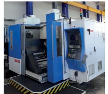
AV Centre de fraisage 5 axes continu UGV - Type K2X8 - Année 2005/2006 en CNC Siemens 840D - Courses X (chariot sur portique) 1000 x Y (table) 700 x Z (vertical) 450 mm - Electrobroche : 16 000 tr/min - Puissance : 36 kW - Table circulaire diam : 500 mm à 2 axes : C rotation 360° vitesse 50 tr/min + A basculement -45°/+180° rotation 50 tr/min - Rapides : 50 m/min - Arrosage au centre : 50 bars - Magasin auto : 100 outils - Tél : 06 88 94 32 50
