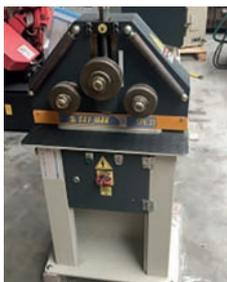
AV Cintreuse de profilés type SPK 30 Neuve - Système horizontal et vertical Diamètre des arbres : 30 mm - Vitesse de travail : 2-4 m/mn - Fer plat : 80 x 15 - Cornière : 40 x 40 x 5 - Carré : 30 x 30 mm - Machine neuve disponible sauf vente entre temps : 3 290 Euros. Tél : 06 07 68 86 74 Mail : lgmo95@orange.fr
