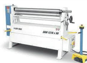
AV Rouleuse motorisée SAY MAK - Type SRM 1050 x 90 - **NEUVE** - Capacité de roulage (longueur x épaisseur) : 1050 x 3 mm - ø du rouleau : 90 mm - ø de cintrage mini (1,5 x ø rouleau supérieur) : 135 mm - Vitesse de roulage : 6 tr/min - Puissance moteur rotation des rouleaux : 1.1 kw - Dim. machine : 1630 x 700 x 1200 mm - Poids : 480 kg
