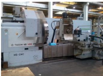
AV Tour TACCHI - Type HD 1450 - CN Num 1060 - ø sur banc : 1300 mm Entrepoinde : 4000 mm - Axe C + Axe Y
