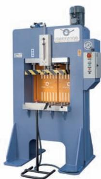
AV Presse Hydraulique Arcade MECAMAQ - Type PDM100 - Force : 100 To - Table : 800 x 500 mm - Coulisseau : 700 x 500 mm guide par deux colonnes - Réglage pression - Double vitesse - Butées électriques de course
