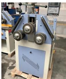
AV Cintreuse de profilés type SPK 35 Neuve - Système horizontal et vertical Diamètre des arbres : 50 mm - Diamètre des galets : 155 mm - Vitesse de travail : 4.5 m/mn - Entraînement des deux galets par motoréducteur : 1.5 kW - Fer plat : 100 x 15 - Cornière : 50 x 50 x 6 UPN : 80 - Carré : 35 x 35 mm - Machine neuve disponible sauf vente entre temps : 4 590 Euros HT Tél : 06 07 68 86 74 Mail : lgmo95@orange.fr
