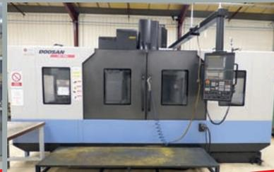
**Centre d'usinage vertical DOOSAN VM750L** - CN FANUC 31i - ST 1900 x 800 mm - Courses 1800 x 750 x 800 mm
