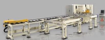
Poinçonneuses cisailles hydrauliques NC et CNC
