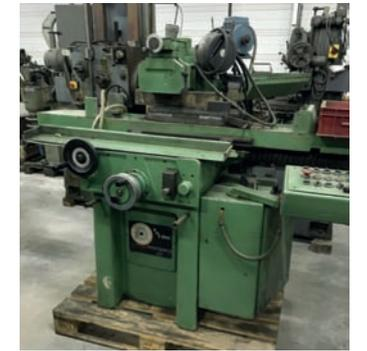
AV Rectifieuse plane MONOPRECIS Type RHE 200 - Surface utile de la table : 500 x 200 - Course longitudinale : 540 mm - Course transversale : 240 mm - Distance maxi de la table sous meule : 400 mm - Vitesse de la meule : 2740 tr/min - Prix : 3 000 Euros HT
