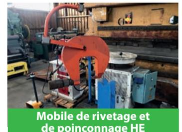
**Mobile de rivetage et de poinçonnage HE**
