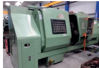
AV Tour CNC MORI SEIKI SL 45 - CNC Fanuc avec conversationnel - Année 1991 en TBE - Mandrin auto 3 mors Kitagawa diam : 380 mm - Longueur de tournage : 1500 x diam 600 mm - Moteur de broche puissance : 30 Kw - Vitesse : 2500 tr/min - Lunette auto SMW Autoblok diam : 35-220 mm livrée en 1999 - Prix : 30 000 Euros - Tél : 06 88 94 32 50
