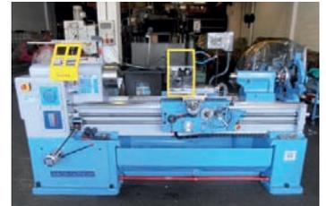
AV Tour parallèle CAZENEUVE HB 575 x 1500 - Reconstituit - Distance entre pointe : 1500 mm - Hauteur de pointe : 250 mm - Diamètre admis au dessus du banc : 575 mm - Diamètre admis au dessus du chariot : 340 mm - Alésage broche : 52 - Conicité de la contre pointe : CM5 - Course maxi du chariot transversal : 400 mm - 18 vitesses de broche : 25 à 2000 tr/min - Puissance moteur de broche : 8,8 kW - Dimensions machine : 2400 x 1180 x 1350 - Protection mandrin
