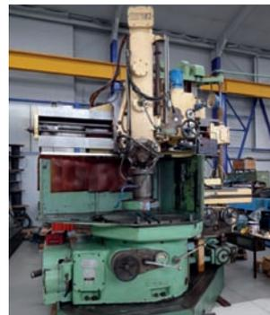
AV Tour verticale adapté en rectifieuse verticale BERTHIEZ - Diam plateau : 1000 mm - Puissance : 22 Kw - Rotation maxi : 175 tr/min - Meule de rectification - 1 coulant vertical avec tourelle et 1 coulant latéral - Excellent état
