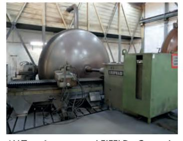
AV Tour à repousser LEIFELD - Cap. acier : 10 mm - Cap. alu : 12 mm - ø maxi : 4450 mm - ø maxi hors sol : 2400 mm - Long. maxi : 2000 mm - Vitesse : 2-300 tr/min
