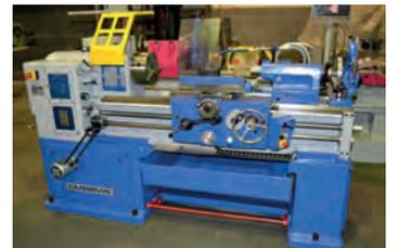
AV Tour parallèle CAZENEUVE - Type HB 500 x 1000 - Machine entièrement reconstruite, refaite à neuf - Distance entre pointe : 1000 mm - Hauteur de pointe : 200 mm - Diamètre admis au dessus du banc : 500 mm - Diamètre admis au dessus du chariot : 220 mm - Alésage broche : 40,5 mm - Conicité de la contre pointe : CM4 - Course maxi du chariot transversal : 400 mm - 18 vitesses de broche : 25 à 2000 tr/min - Puissance moteur de broche : 8,8 kW - Norme CE - Tél : 06 07 68 86 74
