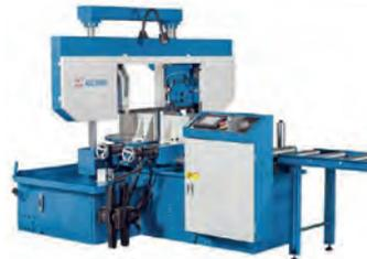
AV Scie à ruban KNUTH ABS 300 NC - Vitesse de coupe : 20-90 m/min - Capacité de coupe 45° : plat 240 x 300 mm, rond 240 mm, carré 240 mm - Positionnement automatique programmable de l'angle par pas de 1° de 0° à 45° - Tél : 05 62 23 73 33
