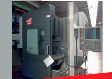
**Centre d'usinage vertical 5 axes HAAS UMC 750** - CN HAAS - ST 500 x 500 mm
