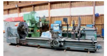
AV Tour GEMINIS GE-1200-25 - 4000 x ø 1200 mm sur le banc et 900 mm sur le chariot - ø dans le rompu : 1600 mm - Avance rapide - Puissance : 25 CV - Broche : ø 102 mm - Tél : 03 88 68 01 37
