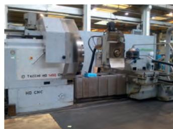
AV Tour TACCHI - Type HD 1450 - CN Num 1060 - ø sur banc : 1300 mm - Entrepointe : 4000 mm - Axe C + Axe Y - Tél : 05 61 78 85 85
