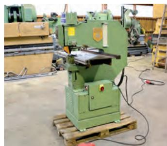
AV Poinçonneuse PEDDINGHAUS 50 tonnes/col de cygne 500 mm Dispositif poinçonnage grand diamètre
