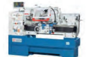
AV Tour KNUTH V-Turn 410/1000 - Entre pointe : 1000 mm - Hauteur de pointe : 205 mm - ø usinable sur banc : 380 mm - Longueur rompu : 250 mm - Course axe X : 210 mm - Course axe Z1 : 140 mm - Cône de broche : CM 6 - Course du fourreau : 120 mm - Tél : 05 62 23 73 33
