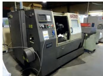
AV Tour CN HARDINGE Cobra 42 - CN Fanuc 21 - Mandrin auto Gamet diam 170 mm - Diam max 209 x longueur 255 mm - Rotation : 5000 tr/min - Puissance : 7,5 kW - VDI 12 positions - Convoyeur Contrepointe - 10 000 Euros - TBE
