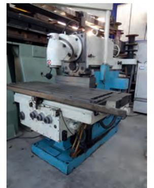
AV Fraiseuse TOS FGS 50/63 - Année 1997 - Table : 1800 x 630 mm - Charge : 1500 kg - Broche ISO 50 - Puissance : 15/20 kW - X 1400, Y 630, Z 500 - Visu 3 axes - Tél : 06 88 94 32 50
