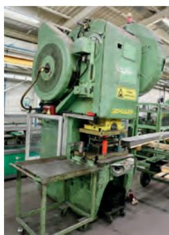
AV Presse mécanique SCHULER - Force : 125 tonnes - 50 cps/min - Tables : 780 x 6200/555/355 mm - Course réglable : 20-120 mm - Tél : 03 88 68 01 37
