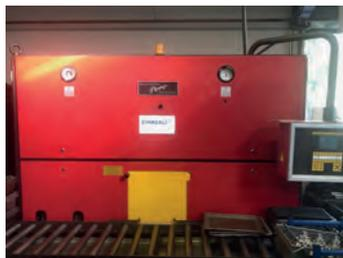
AV Machine de dégraissage automatique
