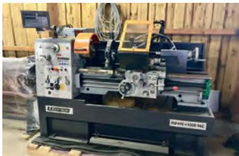
AV Tour à charioter fileter HU 410 x 1000 VAC - Cap. au dessus du banc : 410 mm - Cap. au dessus du chariot transversal : 255 mm - Cap. du rompu : 580 mm - Passage de broche : 52 mm Distance entre pointe : 1000 mm Puissance du moteur principal : 5,5 kW Machine d'expo - Tél : 03 88 68 01 37
