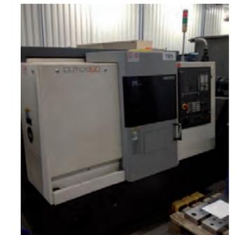
AV Tour à commande numérique HWACHEON - Type CUTEX 160 - Année 2009 - CNC Siemens refaite à neuf 2019 - ø au dessus du banc : 550 mm ø de tournage (std/maxi) : 170/300 mm Longueur de tournage (maxi) : 300 mm Nez de broche : A2-5 - Vitesse maximum : 6000 t/mn - Alésage de broche : ø 56 mm - Passage en barre : ø 45 mm Moteur : 7,5/5,5 kW - Nombre d'outils : 12 - Dimensions de l'outil : carré 25 x 25 et ø 32 mm - Temps d'indexation : 0,15s
