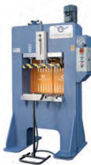
AV Presse Hydraulique Arcade MECAMAQ - Type PDM100 - Force : 100 To - Table : 800 x 500 mm - Coulisseau : 700 x 500 mm guide par deux colonnes - Réglage pression - Double vitesse - Butées électriques de course Grille arrière - Presse Disponible
