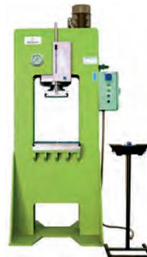
AV Presse arcade MECAMAQ - Type DEVF 100 - Force : 100 To - Table : 500 x 500 mm - Coulisseau : 250 x 250 mm Presse motorisée à commande bi manuelles - Deux vitesses et régulateur de pression
