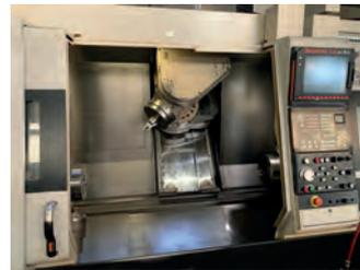
AV MAZAK Integrex 200 - Année 2006 Centre de tournage fraisage 5 axes Bi broches - 4600 tr/min avec axe C Diam maxi usinable : 660 mm - Broche supérieur : 12000 tr/min de tournage et de fraisage avec axe B continu - CN Fusion 640MT Pro - Arrosage au centre Capto C6 avec changeur d'outils - TBE
