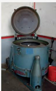
**Essoreuse centrifuge de copeaux RAPIDE**
