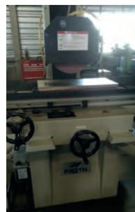
AV Rectifieuse plane PROTH - Type PS GS - 30 60 AH - Dimensions : 600 x 300 mm - Mise aux normes en 2017 Excellent état - 1 diamant de taillage - 1 équilibreur de meules
