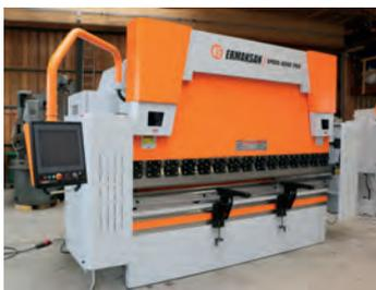
AV Presse plieuse SP - 3000 x 135 tonnes 6 axes + bombage CN - CN Graphique Machine d'expo - Tél : 03 88 68 01 37
