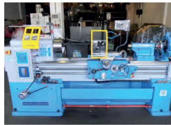
AV Tour parallèle CAZENEUVE - Type HB 575 x 1500 - Reconstituit - Distance entre pointe : 1500 mm - Hauteur de pointe : 250 mm - Diamètre admis au dessus du banc : 575 mm - Diamètre admis au dessus du chariot : 340 mm - Alésage broche : 52 - Conicité de la contre pointe : CM5 - Course maxi du chariot transversal : 400 mm - 18 vitesses de broche : 25 à 2000 tr/min - Puissance moteur de broche : 8,8 kW - Dimensions machine : 2400 x 1180 x 1350 - Protection mandrin - Tél : 06 07 68 86 74
