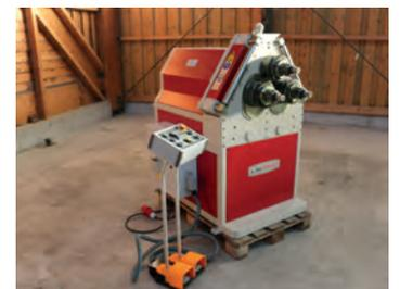
AV Cintreuse à profilés hydraulique d'expo. type 61 - Fer plat sur chant : 80 x 25 Ø 2100 mm - Tube : 60 x 2 Ø 800 mm 2 galets croqueurs - 3 galets entraineurs Visualisation - Garantie 1 an
