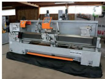
AV Tour à charioter fileter HU 530 x 2200 Vac Topline - 2000 x ø 530mm sur le banc et 240 mm sur le chariot Broche : ø 68 mm - Puissance : 7.5 kW Machine d'expo. - Capacité au-dessus du banc : 530 mm - Capacité au-dessus du chariot transversal : 280 mm - ø rompu : 740 mm - Dia. de la broche de la contre-poupée : 68 mm - Distance entre les centres : 2000 mm - Hauteur de pointe : 260 mm - Broche à trou transversal : 80 mm - Puissance moteur principal : 7,5 kW - Tél : 03 88 68 01 37
