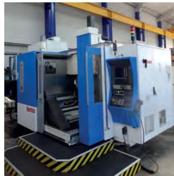
AV Centre de fraisage 5 axes continu UGV - Type K2X8 - Année 2005/2006 en CNC Siemens 840D - Courses X (chariot sur portique) 1000 x Y (table) 700 x Z (vertical) 450 mm - Electrobroche : 16 000 tr/min - Puissance : 36 kW - Table circulaire diam : 500 mm à 2 axes : C rotation 360° vitesse 50 tr/min + A basculement -45°/+180° rotation 50 tr/min - Rapides : 50 m/min - Arrosage au centre : 50 bars - Magasin auto : 100 outils - Tél : 06 88 94 32 50
