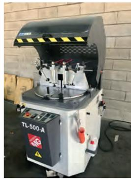
AV Scie aluminium TL 500 A - Lame de la scie : 500 x 50 mm - Puissance moteur : 4 kW - 90° rectangle 300 x 125 mm - 90° rond 180 mm - 90° carré 150 mm - 45° rectangle 145 x 120 mm - 45° rond 180 mm - 45° carré 120 mm - Machine d'expo
