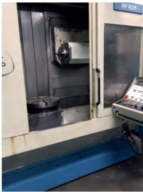
AV Centre d'usinage 5 axes WILLEMIN W428 - CN Fanuc 16i - Plateau : 500 mm Courses : 800 x 500 x 630
