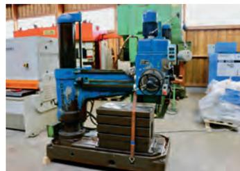
AV Presse radiale GYSIN -  $\phi$  45 mm dans l'acier - Portée max : 1290 mm
