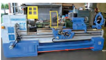
AV Tour parallèle CAZENEUVE - Type HB 800 x 2000 - Reconstitué - Longueur entre pointes : 2000 mm - Diamètre mandrin plateau : 800 mm - Diamètre en mandrin maxi : 400 mm - Diamètre maxi en barre : 80 mm - Diamètre maxi en dessous du banc : 800 mm - Diamètre maxi au dessus du chariot : 740 mm Course maxi du chariot porte outil : 400 mm - Gamme de vitesses de broche : 8-2000 tr/min - Nombre de vitesses de broche : 36 - Tél : 06 07 68 86 74
