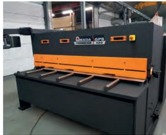
AV Cisaille AMADA 2000 x 4 mm Butée arrière : 1000 mm
