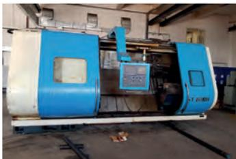
AV Gros Tour CNC JOHNFORD ST 80BH Passage : 1000 mm x 2 m - Entre pointe Lunette - CNC Fanuc 31 i - Mandrin dia : 630 mm - TBE - Tél : 03 88 72 02 47
