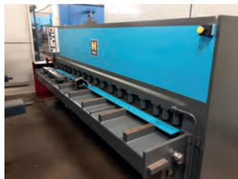
AV Cisaille HACO TS 3006 - Butée arrière électrique : 750 mm - Réglage jeu entre lames - Lames neuves
