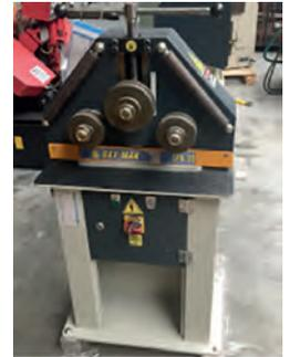
AV Cintreuse de profilés type SPK 30 Neuf - Système horizontal et vertical Diamètre des arbres : 30 mm - Vitesse de travail : 2-4 m/mn - Fer plat : 80 x 15 - Cornière : 40 x 40 x 5 - Carré : 30 x 30 mm - Machine neuve disponible sauf vente entre temps : 3 290 Euros
