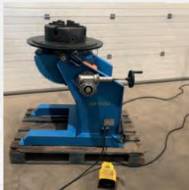
**Positionneur à table tournante AUTOMA SP 500 M**
