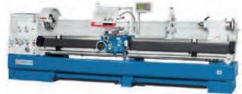
AV Tour KNUTH Turnado 280/1500 V Broche : Camlock - D1-6 - ø usinable sur banc : 560 mm - Course axe X : 316 mm Course axe Z1 : 130 mm - ø du fourreau : 75 mm - Cône du fourreau : CM 5 Course du fourreau : 180 mm
