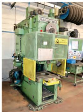
AV Presse mécanique WEINGARTEN ARP 63 - Force : 63 tonnes - 70 cps/min - Tables : 750 x 550/550/350 mm Course réglable : 8-100 mm - Réglage du coulisseau : 63 mm
