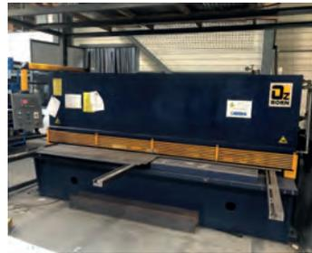
AV Cisaille Guillotine OZBORN - Type CGH 3210 - Année 2013 - Epaisseur de cisailage : 10 mm - Longueur de cisailage : 3200 mm - Passage entre flancs : 3465 mm - Coupe dans l'inox (70 kg/mm<sup>2</sup>) : 5 mm - Nombre coups : 12 - Course butée arrière électrique : 800 mm - Angle de coupe : 1,5° - Col de cygne : 100 mm - Capacité du réservoir d'huile : 300 L - Puissance : 15 kW Dimensions : 3960 x 2270 x 2340 mm Poids : 10 500 Kg - Tél : 06 07 68 86 74
