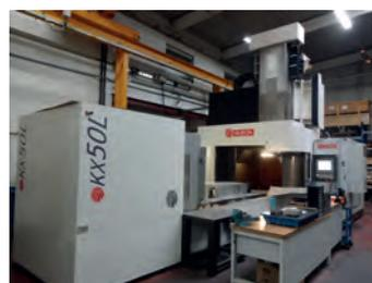
AV Portique UGV 5 axes continu HURON KX 50 L - Année 2013 - CN Heidenhain Itnc 530 - Courses : X 3000 x Y 1700 x Z 800 mm - Table : 3300 x 1250 mm - Tête 2 axes en continu avec électrobroche KESSLER 20 000 tr/mn - HSK63A - 60 kW (S1) - Rapides : 40 m/min - Arrosage centre outil HP 50 bars - Changeur 40 outils - Tél : 06 88 94 32 50
