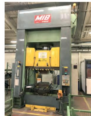
AV Presse hydraulique MIB - Force maxi : 400 tonnes - Course : 700 mm - Tables : 1600 x 1400 mm - Passage outil : 1000 mm - Passage latéral : 1375 - Coussin : 160 Tonnes - Course : 200 mm - Ejecteur : 5 tonnes - Course : 100 mm - Poids : 40 tonnes - Année : 2004
