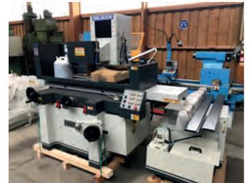
AV Rectifieuse plane EQUIPTOP Capacité : 330 x 915 mm - Semi automatique - Avance rapide
