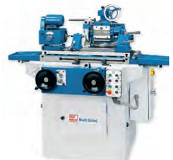
AV Rectifieuse KNUTH Multi-Grind - ø de rectification : 200 mm - Longueur de pièce : 500 mm - Longueur de rectification : 200 mm - Course axe Z : 480 mm - Cône de broche de travail : CM 2 ø mandrin : 100 mm
