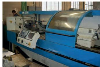
AV Tour CNC par apprentissage STANKO Krasny - De 2006 - CNC Fagor 8055TC EP : 2000 x dia 600 mm
