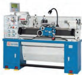
AV Tour mécanique KNUTH Basic 170 Super - Entre pointe : 1000 mm - ø usinable sur banc : 330 mm - Course axe X : 170 mm - Course axe Z1 : 95 mm Passage de broche : 38 mm - Cône de broche : CM 5 - ø du fourreau : 33 mm Course du fourreau : 100 mm
