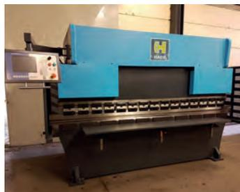
AV Presse plieuse HACO PPES 30080 Rectifiée en haut et bas - Easybend Serrage rapide - Machine équipée d'une table de travail à l'avant
