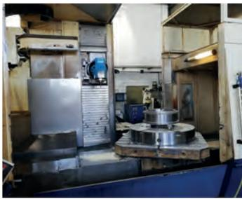
AV Fraiseuse HURON TXD 635 - Année 1999 - CNC Num 1060 - X 2500, Y 1000, Z 1500 mm - Broche : 28 kw - Table : 1500 x 1500 mm - Tél : 06 63 65 11 01
