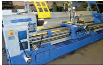
AV Tour parallèle CAZENEUVE - Type HB 725 x 4000 - Reconstitué - Distance entre pointe : 4000 mm - Hauteur de pointe : 315 mm - Diamètre admis au dessus du banc : 725 mm - Diamètre admis dans le rompu : 920 mm Diamètre admis au dessus du trainard : 670 mm - Diamètre admis au dessus du chariot : 400 mm Alésage broche : 81 Conicité de la contre pointe : CM6 Course maxi du chariot transversal : 400 mm - Nombre de vitesses de broche : 18 Rapides longitudinales
