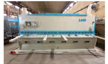
AV Cisaille LVD MVCN 40/8 - Butée arrière électrique : 1000 mm avec affichage - Réglage du jeu entre lames manuel - Embouts plastiques - Col de cygne : 650 fermé - Butée avant : 1500 3 consoles de 1000 avec billes de manutention - Lames neuves
