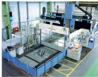
AV Centre d'usinage à portique 5 axes simultanés HEYLINGENSTAEDT pour tournage et fraisage - Année 2009 CN Siemens 840 D - Heures de broche : 4 900 env. - 1 plateau de tournage ø 1250 mm, charge 3000 kg - 1 plateau de tournage ø 2500 mm, charge 10 000 kg Changeur d'outils - Courses : 4500 x 4000 x 1500 mm / W : 1500 mm - Axe B et C : 360°/+110° - Dim de la table : 2500 x 3000 mm - Charge : 15 000 kg
