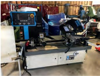
AV Scie à ruban automatique MEP SHARK 281 NC 5.0 - Pour coupe droites et biaises d'un côté jusqu'à 45° (voire 60°, mais uniquement en cycle semi-automatique) - Coupe 90° : dia. 250 mm 280 x 200 mm - Coupe 45° à droite : dia. 190 mm - 180 x 180 mm - Coupe 30° à à droite : dia. 120 mm - 110 x 110 mm Année 2015 - Tél : 03 88 68 01 37
