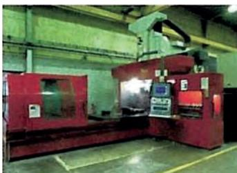
AV Centre d'usinage vertical 5 axes FPT
