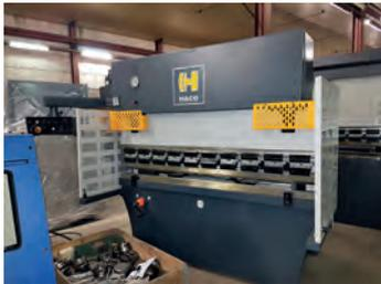
AV Presse plieuse HACO PPH 2040 Butée arrière manuelle - Axe Y motorisé Compteur Siko - Outillage rectifié en haut - Outillage HACO en bas
