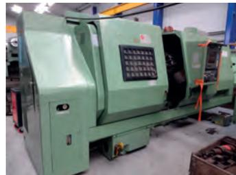
AV Tour CNC MORI SEIKI SL 45 - CNC Fanuc avec conversationnel - Année 1991 en TBE - Mandrin auto 3 mors Kitagawa diam : 380 mm - Longueur de tournage : 1500 x diam 600 mm - Moteur de broche puissance : 30 Kw - Vitesse : 2500 tr/min - Lunette auto SMW Autoblok diam : 35-220 mm livrée en 1999 - Prix : 30 000 Euros - Tél : 06 88 94 32 50
