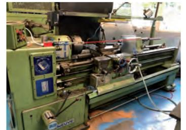
AV Tour parallèle CAZENEUVE - Type HB 500 x 2000 - Distance entre pointe : 1000 mm - Hauteur de pointe : 200 mm ø admis au dessus du banc : 500 mm ø admis au dessus du chariot : 220 mm Alésage de broche : 40,5 mm - Conicité de la contre pointe CM4 - Course maxi du chariot transversal : 400 mm - 18 Vitesses de broche : 25 à 2000 tr/min Puissance moteur de broche : 8,8 kW
