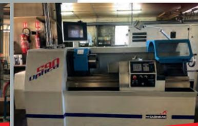
**Tour à commande assistée CAZENEUVE OPTICA 590** - ø de passage au dessus du banc 583 - Longueur 1100 mm
