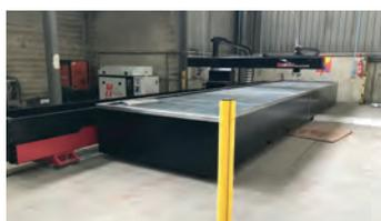
AV Table de découpe jet d'eau Phenix Technologies MDJET 20100A - Table : 10 m x 2 m - Pompe Hypertherm accustream 50 cv / 4137 bars - CNC Phenix sur base PC - Année 2018
