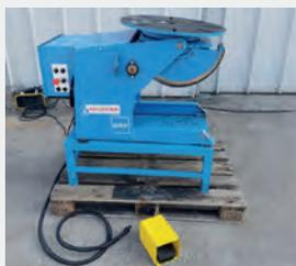
**Positionneur de soudure SAF POSISAF 3F**
