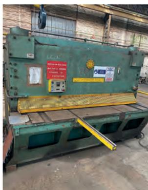
AV Cisaille guillotine LUTHER JORDAN Type AS 2550-12 - Capacité : 2550 x 12 mm - Butée arrière électrique - Course : 750 mm - Tél : 06 07 68 86 74
