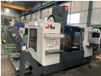
AV Centre d'usinage HAAS - Type VF 4 SS - Année 2011 - Contrôle Haas - Taille de la table : 1324 x 457 mm - Courses XYZ : 1270 x 508 x 635 mm - Vitesse d'avance rapide : 35,6 m/mn - Hauteur min. - max. sous la broche : 102 - 737 mm - Puissance du moteur de broche : 40 Hp - Vitesse de broche : 12 000 tr/min - Capacité de changement d'outils : 24 stations - Taille de l'outil BT40 - Visible en bon fonctionnement - Prix : 30 000 Euros HT chargé - Tél : 03 25 31 92 68 - Mail : lemoine.mo@wanadoo.fr
