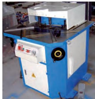
AV Encocheuse hydraulique à angle variable ACCURL - Type AV204
