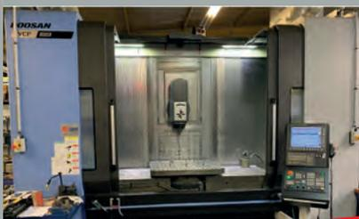
**Centre d'usinage vertical 5 axes DOOSAN VCF850SR** - CNC FANUC 31iB5 - Table 2500 x 870 mm avec plateau intégré ø 800 mm
