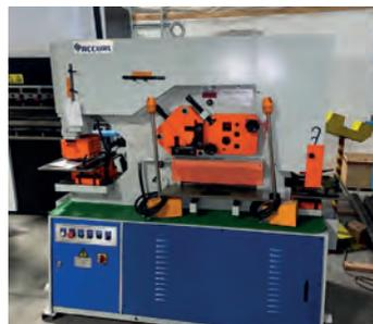
AV Poinçonneuse universelle ACCURL Type IW 60 S - **Machine neuve** - Double poste - Diamètre et épaisseur max. : 28 x 20 mm - Col de cygne : 310 mm - Coupe rond : 40 mm - Coupe carré : 38 mm
