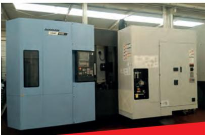
**Centre d'usinage horizontal DOOSAN NHP 5500** - CN FANUC 31i - Palette 500 x 500 mm
