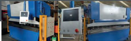
**PRESSE PLIEUSE LAMI NOVA RECONDITIONNEE G 3150 (3000 X 150 t) CN CYBELEC 12 GRAPHIQUE 4 axes Yo - Y - X - R + BOMBAGE et coulisseau positionné par règle électronique**
