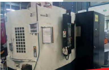
**Centre d'usinage horizontal MAKINO A51** - FANUC 310iS-A - Dim palette 400 x 400 mm - Course XYZ 560 x 560 x 600 mm
