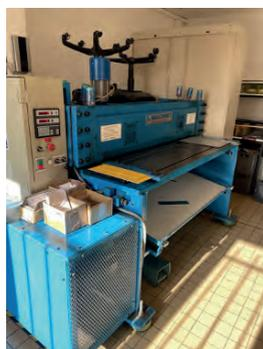
AV Cisaille guillotine VUILLERMET Type LV 1202 - Année de fabrication : 2002 - Capacité : 1200 x 2 mm - Butée arrière électrique avec positionneur Récupération de la tôle vers l'avant Support arrière pneumatique
