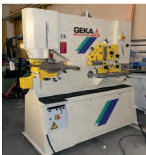
AV Poinçonneuse cisaille GEKA Hydracrop 80 SD à 2 vérins
