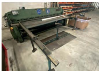
AV Cisaille guillotine BOMBLED Type 209 HK - Capacité : 3020 x 7 mm Presse tôle hydraulique refait (joints et embouts) - Butée arrière électrique, course : 750 mm - Butée arrière refaite à neuf - Remplacement câble et pédale électrique - Lames réaffûtées Régle d'équerre avant de 2500 mm Encombrements : 4600 x 1360 x 1840 mm - Poids : 8000 kg
