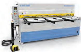
AV Cisaille guillotine mécanique SAY MAK - Type 2060 x 4 mm - **NEUVE** Longueur de cisailage : 2060 mm Epaisseur : 4 mm - Butée arrière CN : 750 mm - Cadence : 41 coups/mm **Machine neuve : 14 990 Euros HT**
