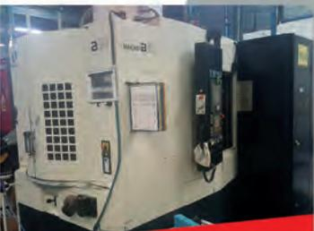
**Centre d'usinage horizontal MAKINO A51** - FANUC 310iS-A - Dim palette 400 x 400 mm - Course XYZ 560 x 560 x 600 mm - Année 2006
