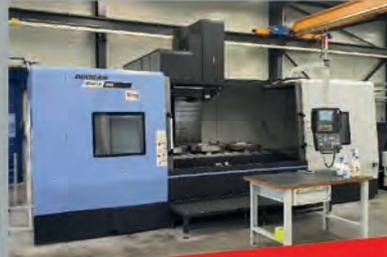
**Centre d'usinage 3 AXES DOOSAN MYNX 9500-50** - CN FANUC OiM - Table : 2500 x 950 mm - Courses : 2500 x 950 x 850 mm - Vitesse de broche 6000 tr/min - BT50 - Année 2018
