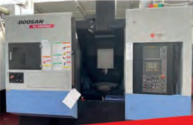
**Centre d'usinage vertical 5 AXES DOOSAN VC630 5AX** - CN FANUC 31iA5 - Table : 630 x 590 mm - Courses : 650 x 765 x 520 mm - Année 2012
