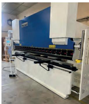
AV Presse plieuse hydraulique ACCURL Type MB7 4200 x 125 T - **Neuve** Puissance : 125 tonnes - Longueur de pliage : 4200 mm - Entre-montant : 3350 mm - Col de cygne : 320 mm Puissance : 11 kW - Encombrement machine : 4890 x 1935 x 2420 mm Poids : 9000 kg - Equipement standard : Système de contrôle : Cybelec Cybtouch (écran tactile) - Nombre d'axes : 2 axes (Y, X) - Bombé de table manuel - Affichage graphique 2D Protection latérale par laser DSP
