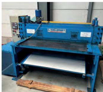
AV Cisaille guillotine VUILLERMET Type LV 1202 - Année de fabrication : 2002 - Capacité : 1200 x 2 mm - Butée arrière électrique avec positionneur Récupération de la tôle vers l'avant Support arrière pneumatique
