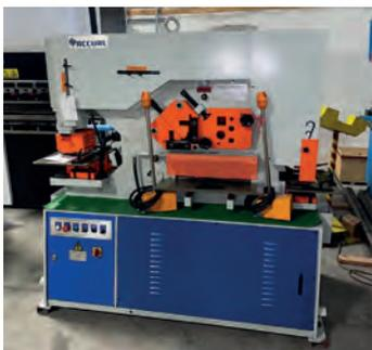
AV Poinçonneuse universelle ACCURL Type IW 60 S - **Machine neuve** - Double poste - Diamètre et épaisseur max. : 28 x 20 mm - Col de cygne : 310 mm - Coupe rond : 40 mm - Coupe carré : 38 mm
