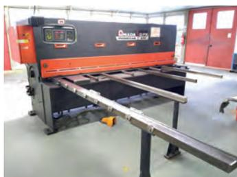
AV Cisaille guillotine hydraulique AMADA - Type GPX 630 - 03/1994 Longueur de coupe : 3000 mm Epaisseur max. pour l'acier : 6 mm Epaisseur max pour inoxydable : 4 mm Epaisseur de coupe en aluminium : 8 mm - Angle de coupe automatique : 1°20 / 2°30 - Butée arrière programmable, course : 1000 mm - Taille de la machine : 4000 x 2100 x 2000 mm - Poids : 6000 kg - Equipements : réglage du jeu entre lame et de l'angle de coupe par CNC Règles d'équerres avant - Support de tôle arrière pneumatique
