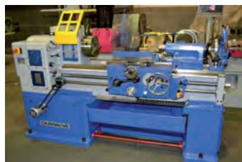
AV Tour parallèle CAZENEUVE - Type HB 500 x 1000 - Machine entièrement reconstruite - Refaite à neuf - Distance entre pointe : 1000 mm - Hauteur de pointe : 200 mm -  $\varnothing$  admis au-dessus du banc : 500 mm -  $\varnothing$  admis au-dessus du chariot : 220 mm - Alésage broche : 40,5 mm - Conicité de la contre pointe : CM4 Course maxi du chariot transversal : 400 mm - 18 vitesses de broche : 25 à 2000 tr/min - Puissance moteur de broche : 8,8 kw - Norme CE
