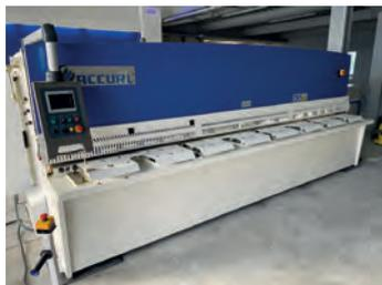
AV Cisaille guillotine hydraulique ACCURL - Type MS7 4200 x 6 mm **NEUVE** - Capacité acier : 4200 x 6 mm Capacité inox : 4200 x 4 mm - Angle de coupe 1,5 - Nombre de vérins serre tôle : 16 - Moteur principal : 7,5 kw - Réglage automatique du jeu entre lames : 0,05 à 0,8 - Longueur de coupe réglable et gérée par la CN - Contrôleur tactile ELGO P40T - Tél : 06 07 68 86 74
