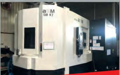
**Centre d'usinage 5 axes horizontal MAKINO A81 M-5XR** - CNC FANUC 310iS - Dim palettes 630 x 630 mm - Courses 900 x 800 x 1020 mm - Année 2013
