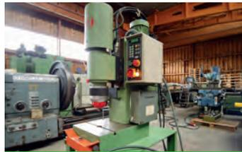
**Riveteuse radiale basée sur système planétaire**
