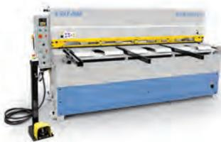
AV Cisaille guillotine mécanique SAY MAK - Type 2060 x 4 mm - **NEUVE** Longueur de cisailage : 2060 mm Epaisseur : 4 mm - Butée arrière CN : 750 mm - Cadence : 41 coups/mn
