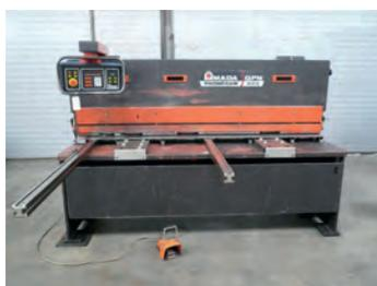
AV Cisaille guillotine AMADA - Type GPN 420 - Longueur de coupe : 2000 mm - Epaisseur de coupe : 4 mm - Butée arrière électrique : 800 mm - Angle de coupe fixe - Réglage du jeu entre lames manuel - Dimensions machine : 2600 x 2020 x 1700 mm - Poids : 3300 kg Evacuateur à bandes
