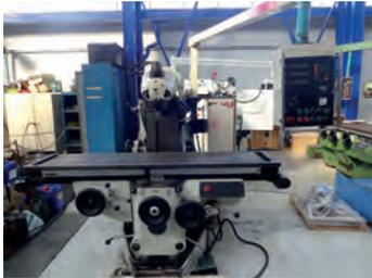
AV Fraiseuse HURON MU6 de 1991 avec variateur d'avances travail - Table : 2000 x 460 mm - Courses : 1500 x 700 x Z 500 mm - Tête SA 50 avec préhension hydraulique - Visu 3 axes Heidenhain
