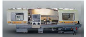
AV Tour FAT 630 x 3000 - CNC Siemens 810D - Manuel Turn - Distance entre pointes : 3000 mm -  $\varnothing$  admis sur banc : 630 mm -  $\varnothing$  admis sur chariot : 370 mm
