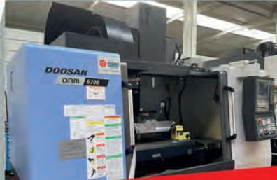
**Centre d'usinage vertical DOOSAN type DNM 5700** - CN FANUC OiM - Table : 1300x570 mm - Courses : 1050 x 570 x 510 mm - Année 2018 - Diviseur 4ème axes ø 260mm
