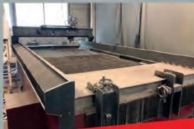
**Machine découpe jet d'eau WATERJET CLASSICA CL612** - Format : 4000 x 2000mm - CN ESA S510 - Option pour découpe tube - Année 2012
