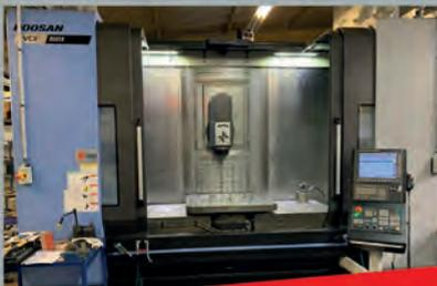
**Centre d'usinage vertical 5 axes DOOSAN VCF850SR** - CNC FANUC 31iB5 - Table : 2500 x 870mm avec plateau intégré ø 800 mm - Courses : 2000 x 850 x 800 mm - Année 2018
