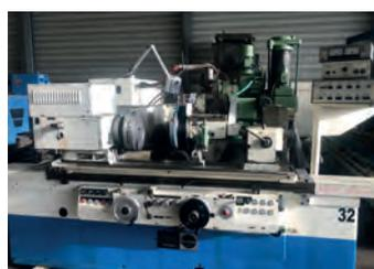
AV Rectifieuse inter exte KARSTENS K11 Capacité : 1000 x 520 mm
