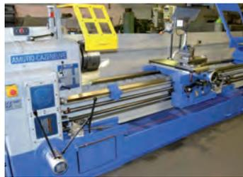
AV Tour parallèle CAZENEUVE - Type HB 725 x 4000 - Reconstituit - Distance entre pointe : 4000 mm - Hauteur de pointe : 315 mm - ø admis au-dessus du banc : 725 mm - ø admis dans le rompu : 920 mm - ø admis au-dessus du trainard : 670 mm - ø admis au-dessus du chariot : 400 mm - Alésage broche : 81 - Conicité de la contre pointe : CM6 Course maxi du chariot transversal : 400 mm - Nombre de vitesse de broche : 18 Rapides longitudinales
