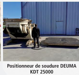
**Positionneur de soudure DEUMA KDT 25000**
