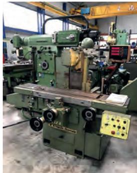
AV Fraiseuse ERNAULT Somua Z1C en état exceptionnel - Table : 1200 x 300 mm (exter) - X 700 x Y 230 x Z 330 mm Cône SA 40 - Visu 3 axes - Rotation maxi tête : 2000 tr/min - Tél : 04 77 29 56 74
