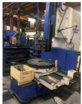
AV Mortaiseuse WALDRICH - Type WS 500 - Capacité extérieure : 800 Capacité intérieure : 435 - Table ø : 900
