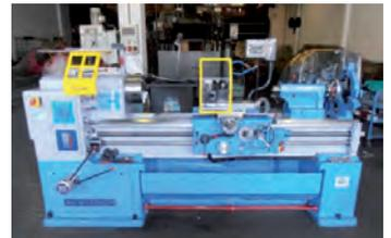
AV Tour parallèle CAZENEUVE - Type HB 575 x 1500 - Reconstitue - Distance entre pointe : 1500 mm - Hauteur de pointe : 250 mm -  $\varnothing$  admis au-dessus du banc : 575 mm -  $\varnothing$  admis au-dessus du chariot : 340 mm - Alésage broche : 52 - Conicité de la contre pointe : CM5 - Course maxi du chariot transversal : 400 mm - 18 vitesses de broche : 25 à 2000 tr/min Puissance moteur de broche : 8,8 kw Dimensions machine : 2400 x 1180 x 1350 Protection mandrin
