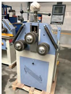
AV Cintreuse de profilés type SPK 35 **Neuve** - Système horizontal et vertical
