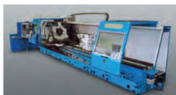
AV Tour POREBA TRP110N 1100 x 4000 CNC Siemens 8540D - Année 2000 Distance entre pointes : 4000 mm ø admis sur banc : 1100 mm - ø admis sur chariot : 740 mm
