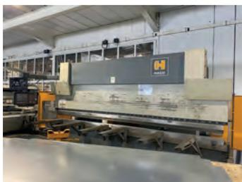
AV Presse plieuse CNC HACO - Type ERMS 40 135 - 2001 - Capacité : 135 T - Longueur de travail : 3600 mm
