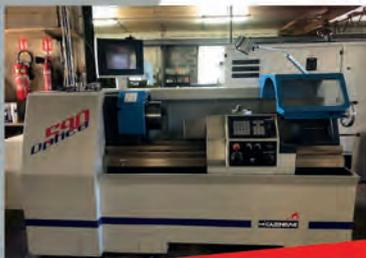
**Tour à commande assistée CAZENEUVE OPTICA 590** - CN NUM POWER PLUS - ø de passage au dessus du banc 580 - Longueur 1100 mm
