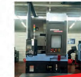
**Tour vertical DOOSAN VT 900M** - CN Fanuc 32iB - ø de tournage 900 mm - AXE C - Année 2015
