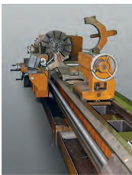
AV Tour PBR T400 x 6000 - Distance entre pointes : 6000 mm - ø admis sur banc : 830 mm - ø admis banc rompu : 1100 mm - ø admis sur chariot transversal : 520 mm
