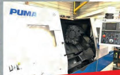
**Tour horizontal DAEWOO TYPE PUMA 250LB** - CN FANUC Série 18-T - Diamètre de tournage : 400 mm - Longueur max d'usinage 1300 mm - Année 1999
