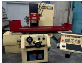
AV Rectifieuse plane JAKOBSEN Plateau magnétique : 600 x 200 mm Hauteur maxi de rectif : 300 mm - Grand choix de rectifieuses de longueur 400 à 2500 mm - Tél : 04 77 29 56 74
