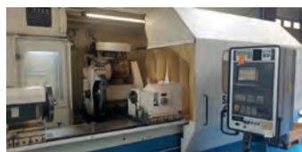
AV Rectifieuse exte cylindrique SCHAUDT SA 7M - CNC Siemens 840C Capacité : 2000 x 620 mm
