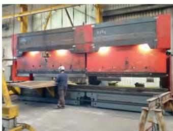
AV Presse plieuse CNC COLLY - Type 7000 x 500 T - 2001 - 6 axes CNC Cybelec DNC 880 S - Capacité : 500 T Longueur de travail : 7000 mm ( 4000 x 3000 mm) - Profondeur du col de cygne : 1000 mm - Ouverture : 400 mm - Course max. : 300 mm - Vitesse d'approche rapide : 100 mm/s - Vitesse de travail : 8,5 mm/s - Vitesse de remontée : 80 mm/s - Puissance moteur : 2 x 18,5 kw
