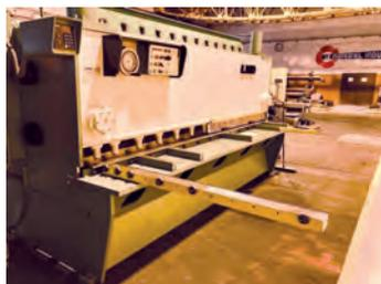
AV Cisaille LVD - Capacité : 3100 x 8 mm Type MVB 31/8
