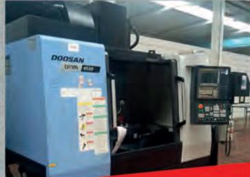
**Centre d'usinage 3AXES DOOSAN type DNM 4500** - CN FANUC I Series - Table : 1000 x 450 mm - Courses : 800x450x510 mm - Année 2017
