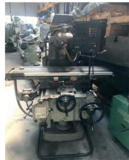
AV Fraiseuse GAMBIN 1M - Table : 1170 x 270 mm - Cône SA 40 - 1800 tr/min Visu 3 axes Heidenhain - X 680 x Y 260 x Z 580 mm - Prix : 4 000 €
