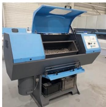
AV Tonneau d'ébavurage DIABOLO Capacité : 100 L - Revêtement intérieur cuve en caoutchouc pour insonorisation - Système d'aspiration avec cartouche filtrante et décolmatage à air comprimé - Gestion de la vitesse de rotation et du temps de cycle
