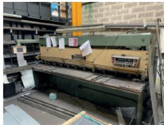
AV Cisaille guillotine NC JEAN PERROT 3000 x 8 mm - Capacité : 3000 x 8 mm - Butée arrière programmable NC Cybelec Cybtouch 6 - Col de cygne : 500 mm - Tél : 06 07 68 86 74
