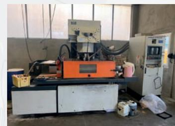
**Machine d'électroérosion par fil CHARMILLES ROBOFIL 6020 SI**
