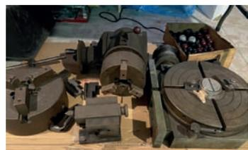
AV Outillage machine-outils - Plateau circulaire horizontal ou vertical ø : 320 mm - Diviseur HP : 145 mm - Mandrin et contre pointe - Mandrin 3 mors concentrique ø : 250 mm
