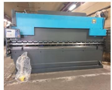
AV Presse plieuse HACO PPH 4 m x 135 T - Rétrofit ATL 565 - Serrage rapide des poinçons - Outillage type System
