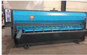
AV Cisaille guillotine HACO TSL 3 m x 6 mm - Rétrofit SP9 - Butée arrière : 1000 mm - Butée équerrage : 1 m - Console avant : 1 m - Table pleine - Lames neuves - Tél : 03 20 10 30 40
