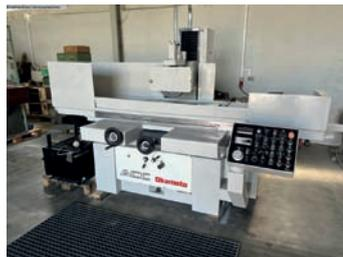
AV Rectifieuse plane OKAMOTO ACC 105DX3 - Capacité : 1000 x 500 mm
