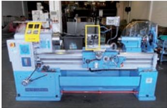
AV Tour parallèle CAZENEUVE - Type HB 575 x 1500 - Reconstituit - Distance entre pointe : 1500 mm - Hauteur de pointe : 250 mm - ø admis au-dessus du banc : 575 mm - ø admis au-dessus du chariot : 340 mm - Alésage broche : 52 - Conicité de la contre pointe : CM5 Course maxi du chariot transversal : 400 mm - 18 vitesses de broche : 25 à 2000 tr/min - Puissance moteur de broche : 8,8 kw - Dimensions machine : 2400 x 1180 x 1350 - Protection mandrin
