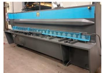
AV Cisaille guillotine HACO HS 4 m x 6 mm SP9 - Butée arrière : 1000 mm Billes de manutention - Jeu entre lames manuel - Butée équerrage : 1000 mm
