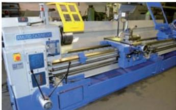
AV Tour parallèle CAZENEUVE - Type HB 725 x 4000 - Reconstituit - Distance entre pointe : 4000 mm - Hauteur de pointe : 315 mm - ø admis au-dessus du banc : 725 mm - ø admis dans le rompu : 920 mm - ø admis au-dessus du trainard : 670 mm - ø admis au-dessus du chariot : 400 mm - Alésage broche : 81 - Conicité de la contre pointe : CM6 Course maxi du chariot transversal : 400 mm - Nombre de vitesse de broche : 18 - Rapides longitudinales
