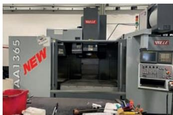
AV WELE AA1365 - Année 2008 - CNC Fanuc 0IMC - Configuré avec la broche ISO 50 - kW 15-18 - Changement d'outil 40 postes - Dimensions de la table : 1450 x 650 mm - Poids max autorisé : 1300 kg - Course longitudinale de l'axe X : 1300 mm - Course transversale de l'axe Y : 650 mm - Course verticale de l'axe Z : 600 mm - Broche 50 ISO - Vitesse de rotation : 6000 tr/min - Convoyeur à copeaux - Prix : 80 000 € HT - Tél : 09 71 46 52 85
