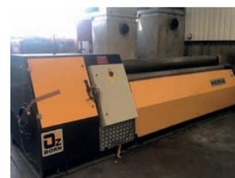
AV Rouleuse hydraulique SAHINLER OZBORN 4R HS 30-260 - Année 2011 Roulage (Lg x ép.) : 3100 x 8 mm Croquage (Lg x ép.) : 3100 x 6 mm - ø des rouleaux intérieurs : 260 mm - ø des rouleaux latéraux : 200 mm - Moteur principal : 7,5 kW - Vitesse de travail : 1,5 à 6 t/mn - Dim. machine (Lg x l x H) : 4850 x 1450 x 1700 mm - Poids : 7900 kg - Tél : 06 07 68 86 74
