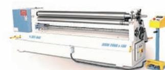
AV Rouleuse asymétrique motorisée Type SIRM 2050 x 4 mm - Neuve Capacité de roulage (longueur x épaisseur) : 2050 x 4 mm - ø du rouleau : 140 mm - ø de cintrage minimum : 210 mm - Vitesse de roulage : 3,5 / min - Puissance moteur rotation des rouleaux : 2,2 kW - Dispositif de roulage conique - Panneau de commande sur pied - Normes CE - Dimensions machine : 3200 x 750 x 1000 mm - Poids : 1700 kg - Tél : 01 39 99 52 85
