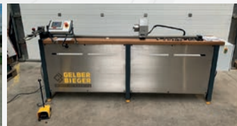
Cintreuse à tube GELBER BIEGER HRB 16NC Année de construction 2020 - quasi neuve Mandrin 4 mors ø 100 mm Cintrage jusqu'à 16 mm
