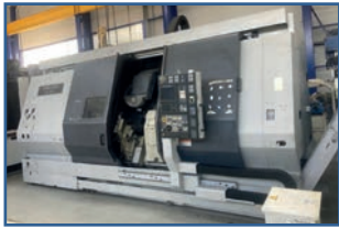
Centre de tournage fraiseuse 5 axes Mori Seiki Fanuc 18i-T - Capacité \varnothing 420 x lg 1530 mm Broche tournage + broche de fraiseuse Axe B continu + 105° / -120° - axe C 0,001°
