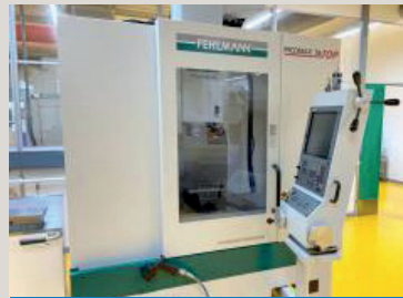
Stock no. : 22184 Machine : Perceuse fraiseuse CNC Modèle : FEHLMANN Picomax 56 TOP Control : HEIDENHAIN TNC 620
