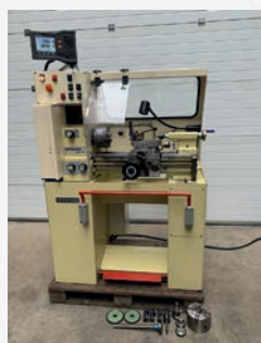
Tour parallèle WEILER PRIMUS Entre-pointes 400 mm ø maxi sur le banc 250 mm ø maxi au-dessus du trainard 130 mm
