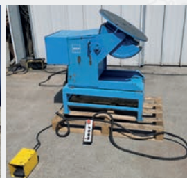
Positionneur de soudure REALMECA MEMORAX 3FP Charge toutes positions 400 kg Inclinaison automatique 0 - 135° Plateau ø 600 mm
