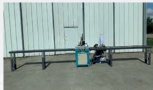
Fraise scie tronçonneuse alu EISMO KD 400 PS Année de construction 2016 Vitesse de broche 3000 t/min Coupe droite et biaise jusqu'à 45°
