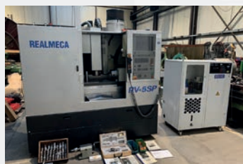
Centre d'usinage vertical REALMECA RV-5SP Courses X 500 mm - Y 350 mm - Z 400 mm Commande HEIDENHAIN TNC 426 Table 600 x 350 mm Magasin 18 outils - HSK 40
