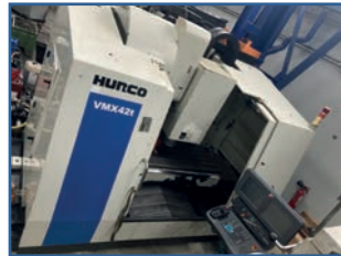
Centre d'usinage vertical 3 axes Hurco VMX 42t 2008 CN WinMax Ultimax 4 - Table 1270 x 610 mm X 1067 x Y 610 x Z 610 - Big Plus ISO 40 12k tr/min Changeur 24 outils - Arrosage centre broche
