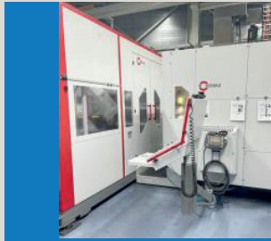
Stock no. : 22120 Machine : 2 Centres d'usinage 5 axes avec robot de charge Modèle : HERMLE C 42 Control : HEIDENHAIN TNC 530
