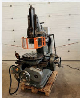
Mortiseuse GSP MORT 730 Course coulisseau 170 mm Profondeur col de cygne 450 mm Table tournante ø 500 mm
