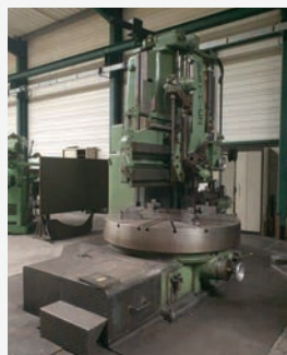
Tour vertical BERTHIEZ 9340/4 ø maxi de tournage 3200 mm Hauteur usinable 1660 mm Plateau ø 1800 mm Visu 2 axes HEIDENHAIN Course vertical du coulant 975 mm
