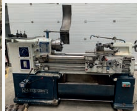
Tour parallèle CAZENEUVE HB500 x 1000 mm Entre-pointes 1000 mm ø maxi sur le banc 500 mm ø maxi au-dessus du trainard 220 mm Passage de broche ø 41 mm
