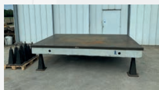
Marbre lisse en fonte STOLLE 3500 x 2500 x épaisseur 305 mm Hauteur sur pieds 900 mm Poids 6,3 T Fournis avec 12 pieds de nivellement
