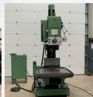
Perceuse radiale SCHLUMBERGER type RF6 Cône CM4 Broche ø 90 mm Sortie de broche ø 240 mm Vitesse de broche de 35 à 1800 t/min
