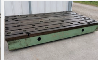
Taques en fonte rainurées 3000 x 1750 x épaisseur 350 mm Poids env. 5 T + autres dimensions disponibles
