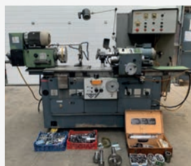
Rectifieuse intérieure VOUMARD 5S Hauteur de pointe 180 mm Diamètre de rectification ø 5 à 200 mm
