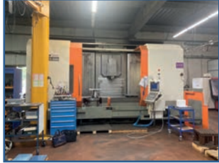
Centre fraiseuse 5 axes av table circulaire intégrée - Année 2013 CN Heidenhain iTNC 530 Table 3500 x 700 mm - X 3000 x Y 700 x Z 780 Broche BT 40 - 12.000 tr/min - 26 kW Tête B continu +/- 110° - Axe C 360° \varnothing 630 mm
