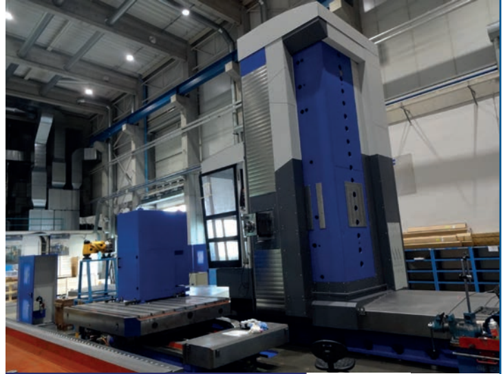
Aléuseuse fraiseuse TOS WHN 130 de 2003 Heidenhain TNC 430 - Table 1600 x 1800 B continu - X 2000 x Y 2500 x Z 1250 x W 800 mm Broche ISO 50 \varnothing 130 mm 2500 tr/min Tête de fraiseuse et plateau à surfaçer
