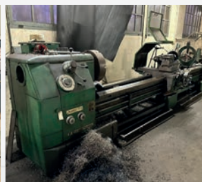
Tour parallèle ERNAULT SOMUA JUPITER 830 Entre-pointes 3000 mm ø maxi sur le banc 830 mm ø maxi au-dessus du trainard 520 mm Passage de broche ø 76 mm
