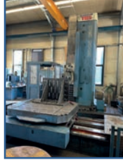
Aléuseuse fraiseuse TOS WHN 130 de 2003 Heidenhain TNC 430 - Table 1600 x 1800 B continu - X 2000 x Y 2500 x Z 1250 x W 800 mm Broche ISO 50 \varnothing 130 mm 2500 tr/min Tête de fraiseuse et plateau à surfaçer
