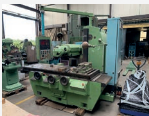
Fraiseuse universelle HURON P2771 Courses X 1800 mm - Y 1000 mm Z 1000 mm - Cône SA50 Table 2235 x 700 mm Vitesse de rotation de 30 à 2066 t/min
