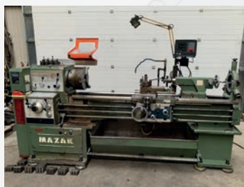
Tour parallèle MAZAK ø 500 mm Entre-pointes 1500 mm ø maxi sur le banc 500 mm ø maxi au-dessus du trainard 240 mm
