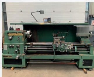
Tour parallèle ERNAULT SOMUA CHOLET 660 Entre-pointes 1800 mm ø maxi sur le banc 660 mm ø maxi au-dessus du trainard 360 mm
