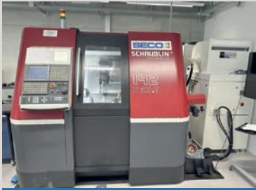
Stock no. : 22192 Machine : Tour CNC Modèle : SCHAUBLIN 142-T1AX-Y Control : FANUC Series 31i-Model B
