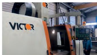
AV Centre d'usinage VICTOR V Center 130 - Fanuc - Courses : 1300 x 600 x 600 mm - BT 40 - Changeur 24 outils - Tél : 06 63 65 11 01
