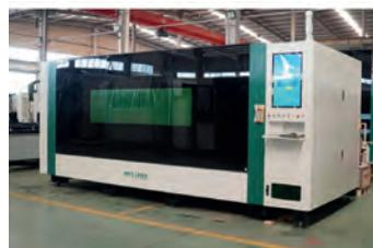
AV Machine de découpe laser fibre
