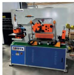
AV Poinçonneuse universelle **ACCURL** - Type IW 60 S - **Machine neuve** - Double poste - Diamètre et épaisseur max. : 28 x 20 mm - Col de cygne : 310 mm - Coupe rond : 40 mm - Coupe carré : 38 mm Cornière : 130 x 130 x 12 mm - Fers plats : 350 x 15 mm - Puissance moteur : 5,5 kw - Poids : 1780 kg Dimensions machines : 1700 x 800 x 1710 mm - Puissance : 60T - Avec jeu de 10 poinçons matrices ø : 8-10-12-14-16-18-20-22-24-26 jeu de 3/10 - Prix : 9 990 €
