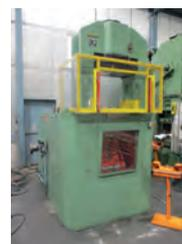
AV Presse à genouillère **GRABENER** Type G K 360 S - Largeur entre montants : 700 - Course : 120 m/m - Machine reconstruite Conforme control APAVE - Visible en fonctionnement
