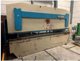
AV Presse plieuse LVD - Type PPBL 100/40 ELGO 88 - Année de fabrication : 1995 - Longueur de pliage : 4000 mm - Col de cygne : 200 mm - Entre montants : 3150 mm - Tonnage : 100 tonnes Butée arrière électrique : 650 mm - Commande bi-manuelle Puissance moteur : 6,5 kw - Poids : 8 200 kg - Tél : 06 07 68 86 74
