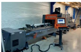
AV Centre usinage TEKNA TKE 944 - 4 axes - 7 mètres - Usinage de profilés (Alu, Acier, PVC, Inox) Travail en mode pendulaire (2 zones)
