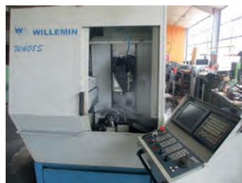
AV Centre d'usinage WILLEMIN MACODEL Type W 408 S Année 2000 - CN Fanuc - 5 axes Avec accessoires - Visible en bon fonctionnement
