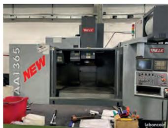
AV Centre d'usinage vertical WELE AA1365 - Année 2008 - **Temps de fonctionnement : 6 735 h** - CNC Fanuc 18i - Écran 10.4" - Configuré avec la broche ISO 50 - 15-18 kw Changement d'outils 40 postes Dimensions de la table : 1450 x 650 mm - Poids max autorisé : 1300 kg Course longitudinale de l'axe X : 1300 mm - Course transversale de l'axe Y : 650 mm - Course verticale de l'axe Z : 600 mm - Broche ISO 50 Vitesse de rotation : 6000 tr/min Convoyeur à copeaux
