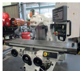
AV Fraiseuse HURON MU6 Machine reconstruite mécanique et géométrie - Surface table : 2000 x 460 - Cône de broche : SA 50 - Course longitudinale : 1500 mm - Course transversale : 700 mm - Course vertical : 500 mm 27 vitesses de broche : 30 à 2066 tr/min - Avance rapide : 2 800 mm/min variateur - Visu 3 axes
