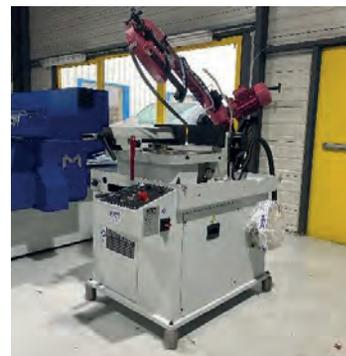
AV Scie à ruban coupe angles BEHRINGER SLB 230 DG - Sections : 280 x 210 - Angles : -45° à +60°
