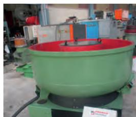
AV Vibrateur PARKER ROSLER Type TM 22 - 470 litres - Visible en bon fonctionnement
