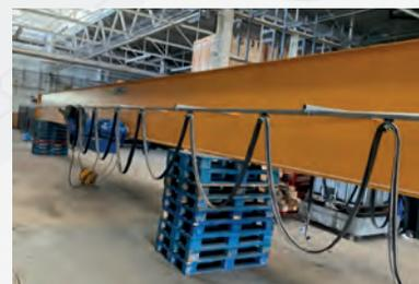
**Pont roulant monopoutre SADAMEC**
