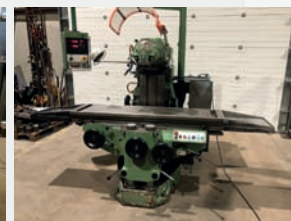
Fraiseuse universelle HURON MU5 - Variateur avances Courses X 1300 mm - Y 700 mm Z 500 mm - Broche SA 40 Table 1630 x 460 mm Vitesse de rotation de 30 à 2066 t/min
