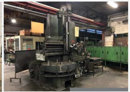
Tour vertical GRAFFENSTADEN Ø maxi de tournage 1500 mm Ht maxi de tournage sous traverse 1300 mm Mandrin Ø 1400 mm
