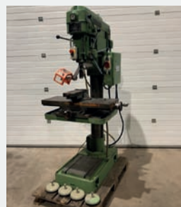
Perceuse à colonne ALZMETALL AB4/SV Broche CM4 Sortie de broche 150 mm Course table X 400 mm / Y 250 mm Profondeur col de cygne 350 mm
