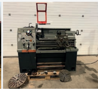
Tour parallèle COLCHESTER MASTER 2500 Entre-pointes 635 mm Ø maxi sur le banc 335 mm Ø passage de broche 40 mm
