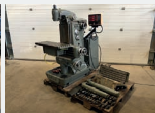
Fraiseuse universelle DECKEL FP2 Courses X 500 mm - Y 200 mm Z 390 mm - Cône SA 40 Table 700 x 285 mm Vitesse de rotation de 40 à 2000 t/min
