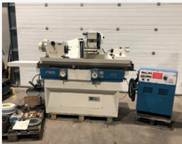
Rectifieuse cylindrique int/ext SIT U700 CA Ø de rectification 300 mm Longueur maxi de rectification 700 mm Prof maxi de rectification 122 mm Poids maxi de la pièce 120 kg
