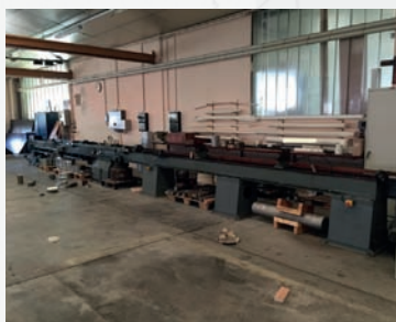
Rodeuse horizontale MAUSER Capacité de rodage maxi Ø 100 mm Lg de rodage 6000 mm Lg totale de la machine : 14 mètres Machine en 3 éléments
