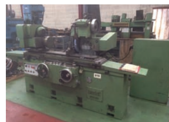
AV Rectifieuse cylindrique universelle DANOBAT 800RP - Distance entre pointes : 800 mm - \phi sur le banc : 350 mm - Plongée auto - Plateau magnétique Broche inter - Tél : 06 75 49 57 65
