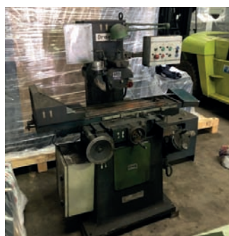
AV Rectifieuse plane PRAGA - Type 452 PA licence JONES & SHIPMAN 540 PA - Année : 1995 - Prise de passe automatique - Dimensions table : 457 x 152 mm - Dimensions meules : 180 x 13 x 31,75 mm - Vitesse de la meule : 3000 t/min - Puissance de la poupée porte meule : 1,5 kW - Prix HT : 2 500 Euros Tél : 06 07 68 86 74
