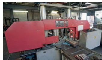
AV Scie à ruban automatique BEHRINGER type HBP 430 A - Année 2005 - ø de coupe maxi : 430 mm Dim. de coupe maxi en carré : 430 mm Amenage auto. : 500 mm - Variateur de vitesses : 19 à 130 m/mn - Avance de sciage hydraulique - Machine équipée avec : convoyeur à copeaux, table d'alimentation et d'évacuation lg : 1000 mm Disponible en février 2020 Tél : 03 80 78 72 62 Mail : behringer-france@wanadoo.fr
