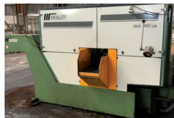
AV Scie à ruban automatique MISSLER DEB 340 CE - Année 1998 - Capacité de coupe maxi : 340 x 340 mm - Dimension du ruban de scie : 34 x 1,1 x 5000 mm Vitesse du ruban de scie : 10 - 120 m/min - Puissance totale machine : 8 kW Tél : 04 77 73 00 82
