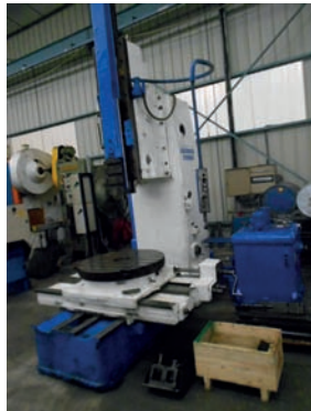
AV Mortaiseuse WALDRICH - Type WS 500 - Capacité extérieure : 800 Capacité intérieure : 435 - Table ø : 900 Tél : 03 25 31 92 68 Mail : lemoine.mo@wanadoo.fr
