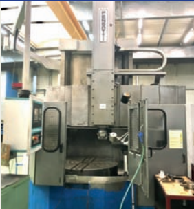
Tour vertical CNC PENSOTTI TP 1250 (rétrofit 2005)
