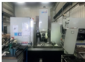
AV Fraiseuse par apprentissage SOMAB Univers 500 - De 2001 - CNC Somap S5 Courses : 1200 x 510 x 500 mm Tél : 03 88 72 02 47
